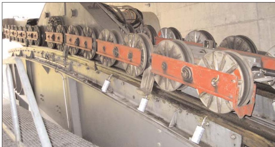
Die Gleit- und Rollreibung sowie Rostbildung können bei wechselnden Wetterbedingungen von simalube und seiner kontinuierlichen Schmierstoff-Abgabe verhindert werden.
