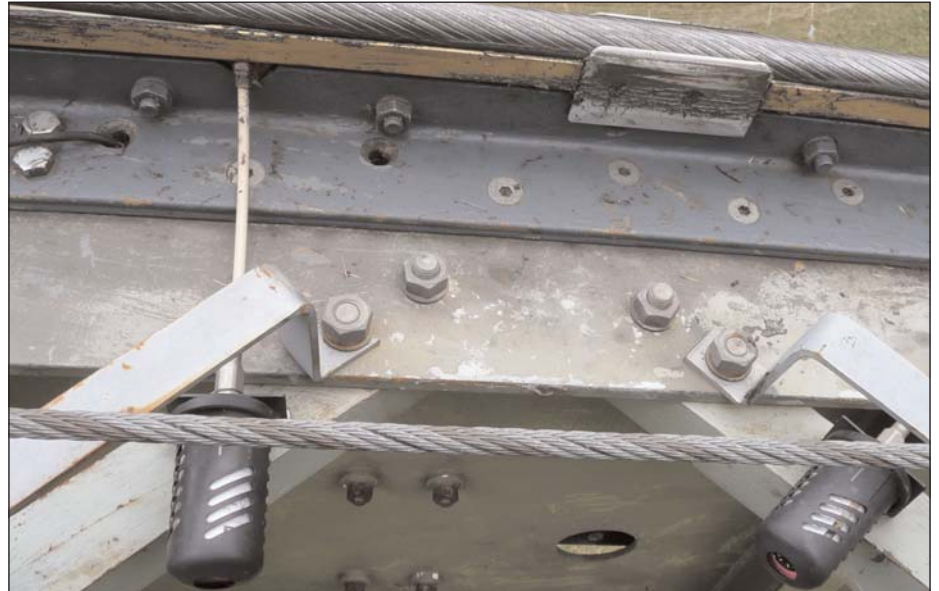
Mit der optimalen Abgabe an Schmierstoff an die richtige Stelle entsteht keine Über- oder Unterschmierung. Zudem enthält der Spender keine giftigen Flüssigkeiten.
