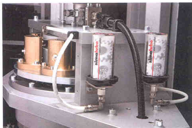
Simalube im Einsatz mit Zufuhrschlauch.
